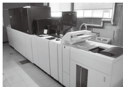
小ロットの印刷で活躍する高速オンデマンド印刷機。白、金、銀等の特色の印刷や可変印刷も可能。
