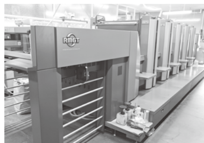
4色カラー印刷にニスや金銀も同時に印刷可能な5色オフセット印刷機
